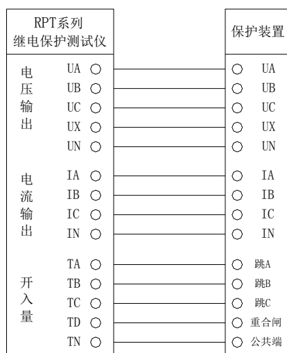
图 3-1 距离保护及重合闸接线图
