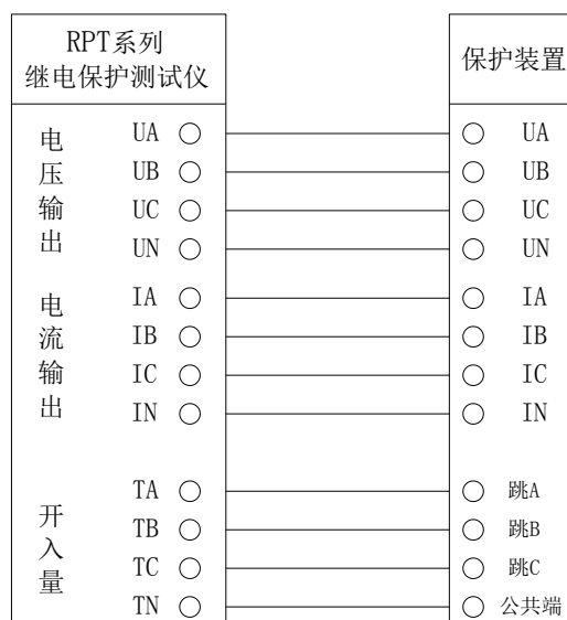
图 3-1 距离保护接线图
